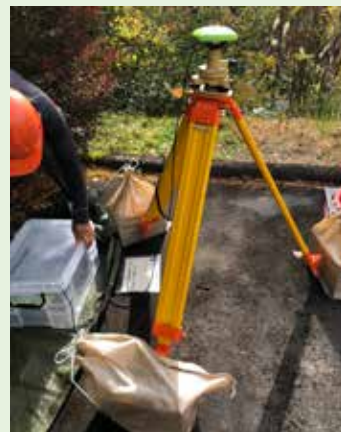
白根山の南東麓での観測。三脚に乗せられたGNSSアンテナ。
