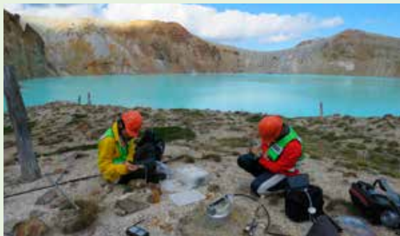
湯釜火口内とその周辺での地中ガスの採取と測定。
